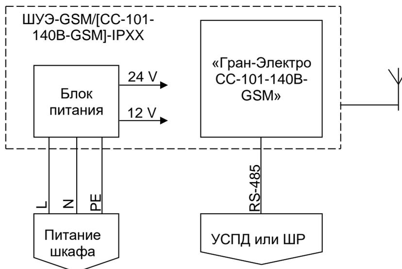
Рисунок 1.3 – Структурная схема НКУ исполнения ШУЭ-GSM/[CC-101-140B-GSM]-IPXX
