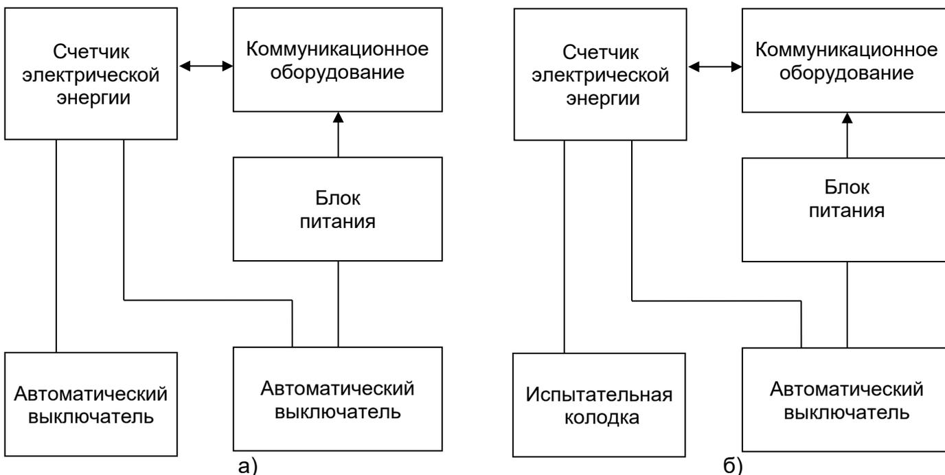
Рисунок 1.2 – Общая структурная схема ШУЭ со счетчиком, где а) счетчик непосредственного включения, б) счетчик трансформаторного включения
