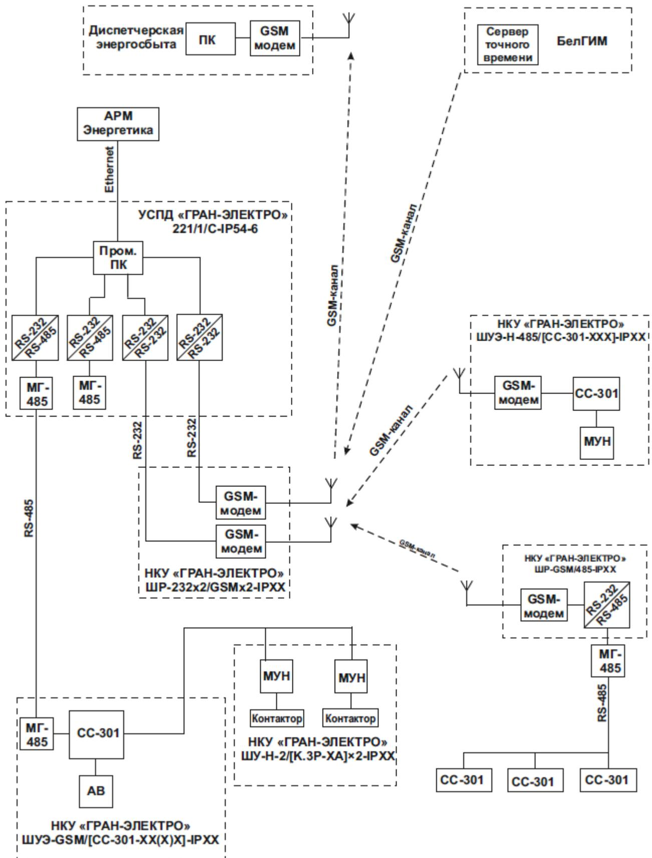
Рисунок 1.4 – Пример построения АСКУЭ с использованием НКУ, где АВ – автоматический выключатель; МГ-485 - модуль грозозащиты МГ-485; МУН – модуль управления нагрузкой; ПК – компьютер
